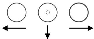
Les boutons de droite et de gauche permettent de naviguer entre les 4 écrans principaux. Le bouton du milieu permet de changer l'échelle de l'écran. par exemple, consommation de l'heure en cours, du jour en cours, etc.
